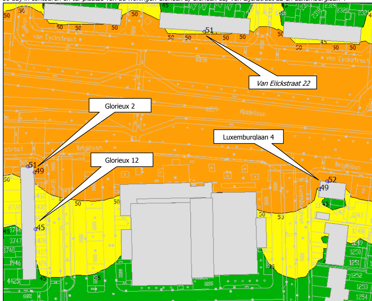
Figuur 1: Het referentieniveau van het omgevingsgeluid (equivalent geluidniveau als gevolg van de Middellaan vermindert met 10 dB) in contouren en ter plaatse van de woningen Glorieux 2, Glorieux 12, Van Eijckstraat 22 en Luxemburglaan 4
