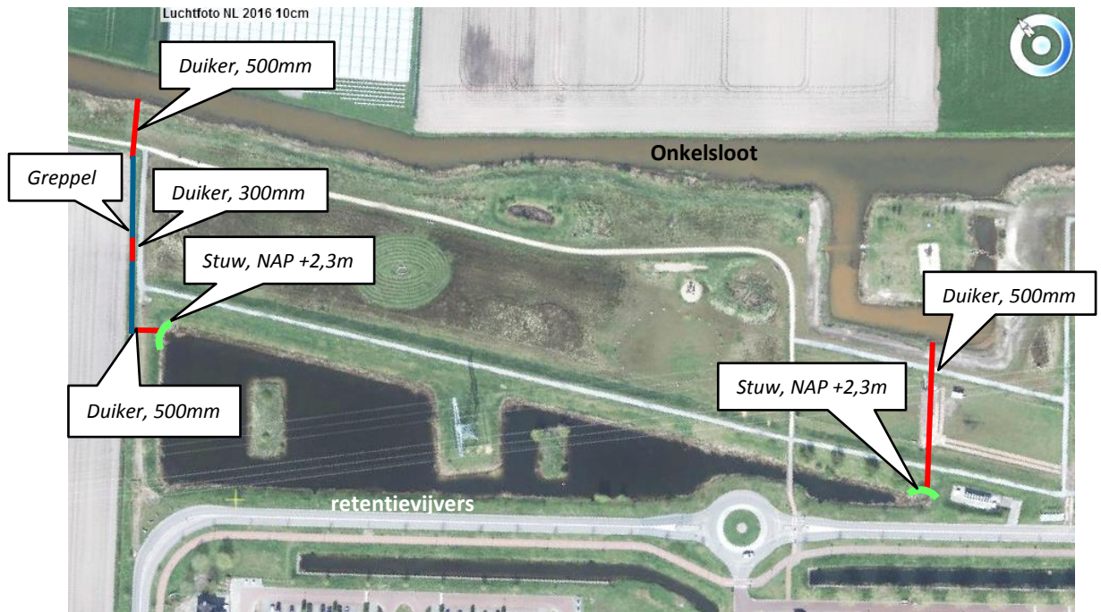
Figuur 2-4: Afvoersysteem vanaf de retentievijvers in De Beljaart naar de Onkelsloot (bron: Cyclomedia 2016)
