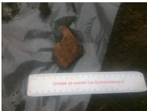
Foto 5. Asbesthoudend materiaal gat 05
